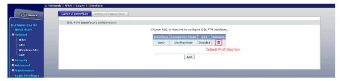
Unter -> Netzwerk -> Layer2Interface Profil mit VLAN MUX-Mode erstellen.
